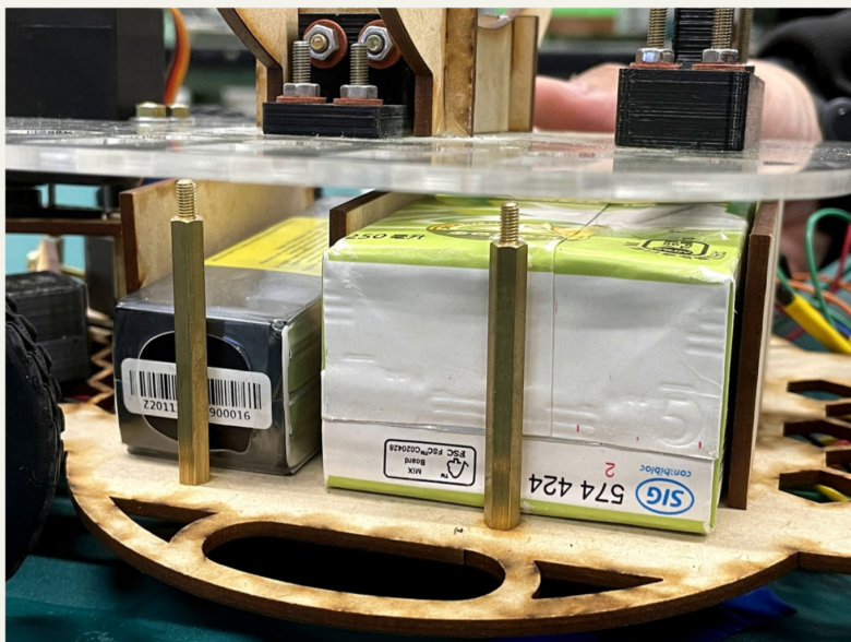
圖3-5、三層隔板+銅柱固定(另一側也會有兩根銅柱)
